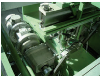
Particolare sistema di cordonatura
